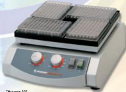
Titramax 101 P/N 544-11300-00 Titramax 100 (not shown) P/N 544-11200-00
